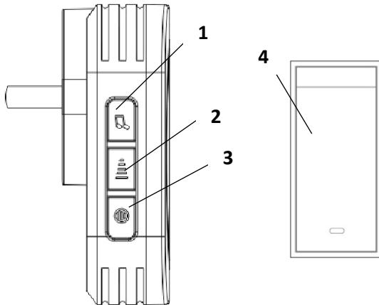
**Poznámka:** Zvonek pracuje na frekvenci 433MHz. Dosah je maximálně 150m na otevřeném prostranství. Vysílač je vybaven zařízením, které přemění mechanickou energii na elektrickou. Není potřeba vkládat baterii ani o vysílač nijak zvlášť pečovat.
